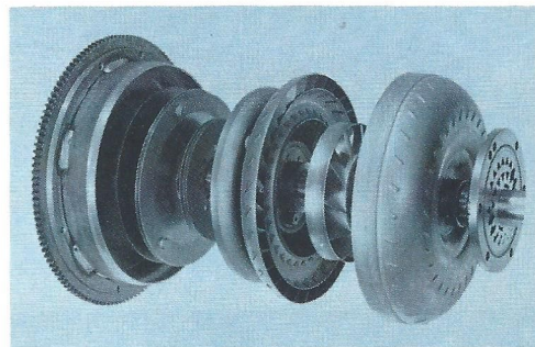
Photo d'identité du convertisseur de couple GS (sous son meilleur profil). De bas en haut : couronne du démarreur, plateau de pression, disque d'embrayage, carter d'embrayage, roue de turbine, réacteur monté sur roue libre, roue de pompe (en relation avec la turbine) pompe à huile. (Photo Citroën 18.114).
